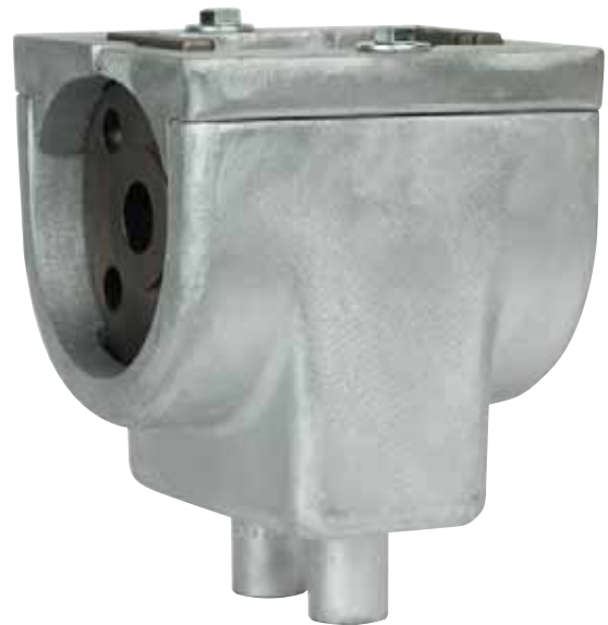
Fig. 3 Enveloppe pleine utilisant les brides standard du robinet (Pressions nominales des enveloppes: 150 & 300 lbs)
